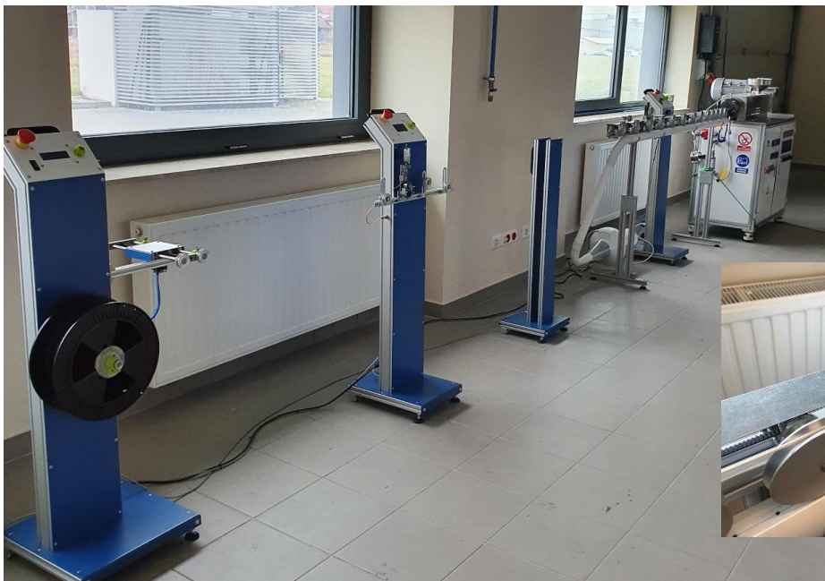
Linia do otrzymywania kompozytów w technologii Rapid Prototyping
