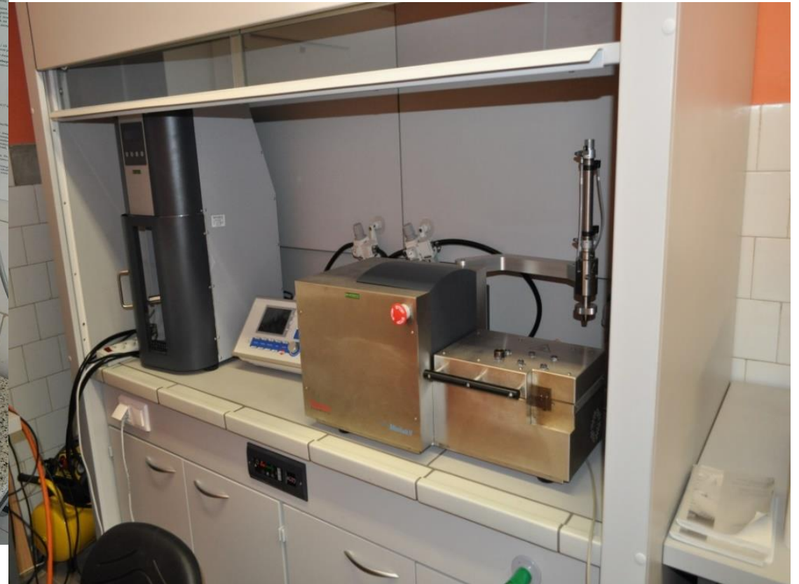
Przygotowanie nanokompozytów polimerowych z wykorzystaniem miniwtryskarki i miniwylączarki
