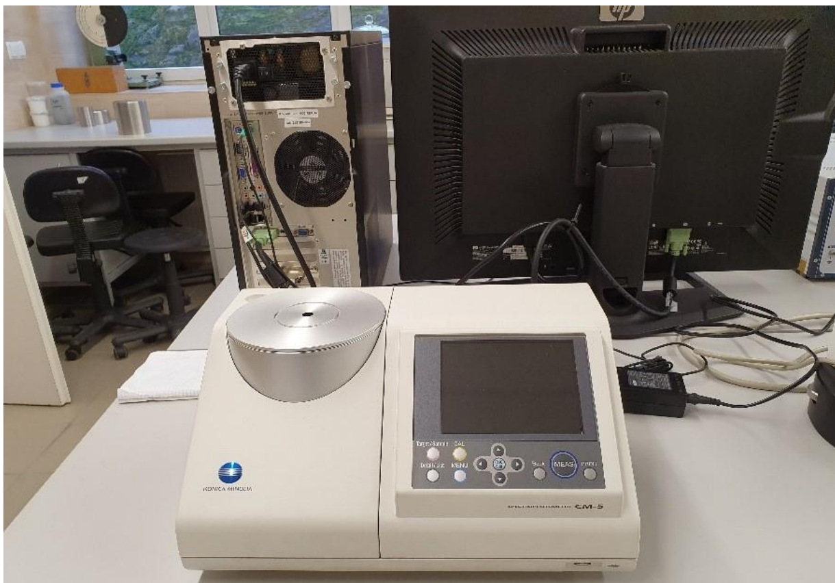
Spektrometr do oznaczania barwy wyrobów polimerowych, firmy Konica Minolta
