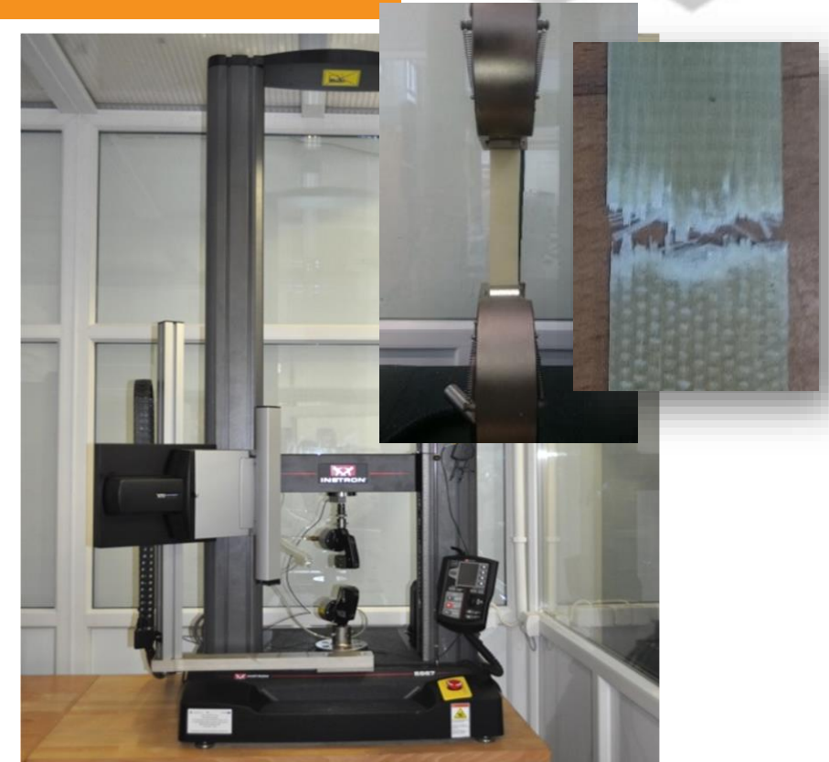
Maszyna wytrzymałościowa do badania wytrzymałości na rozciąganie, zginanie, ściskanie i ścinanie
