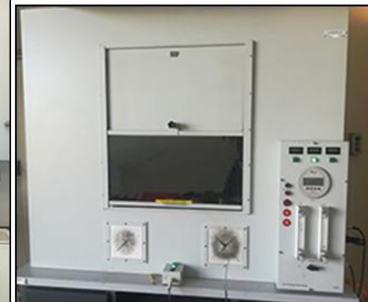
Komora UL94 do określania klas palności
