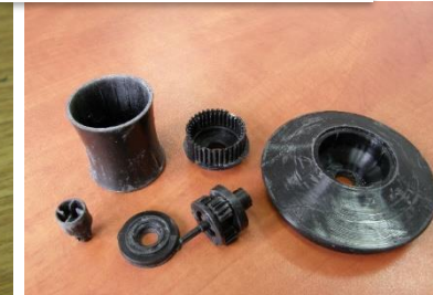
Komora próżniowa i widok elementów przekładni robota kuchennego odlanych w formie silikonowej
